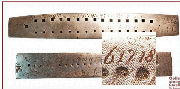
Altri due esempi di trafilè più antiche presenti nella Collezione Garuti Ritrazzate a mano dagli orafi, riportano la data di fabbricazione e le iniziali degli artigiani 1826 e 1839 Provenienza: donazione di R. Venturi e O. Cavalieri
