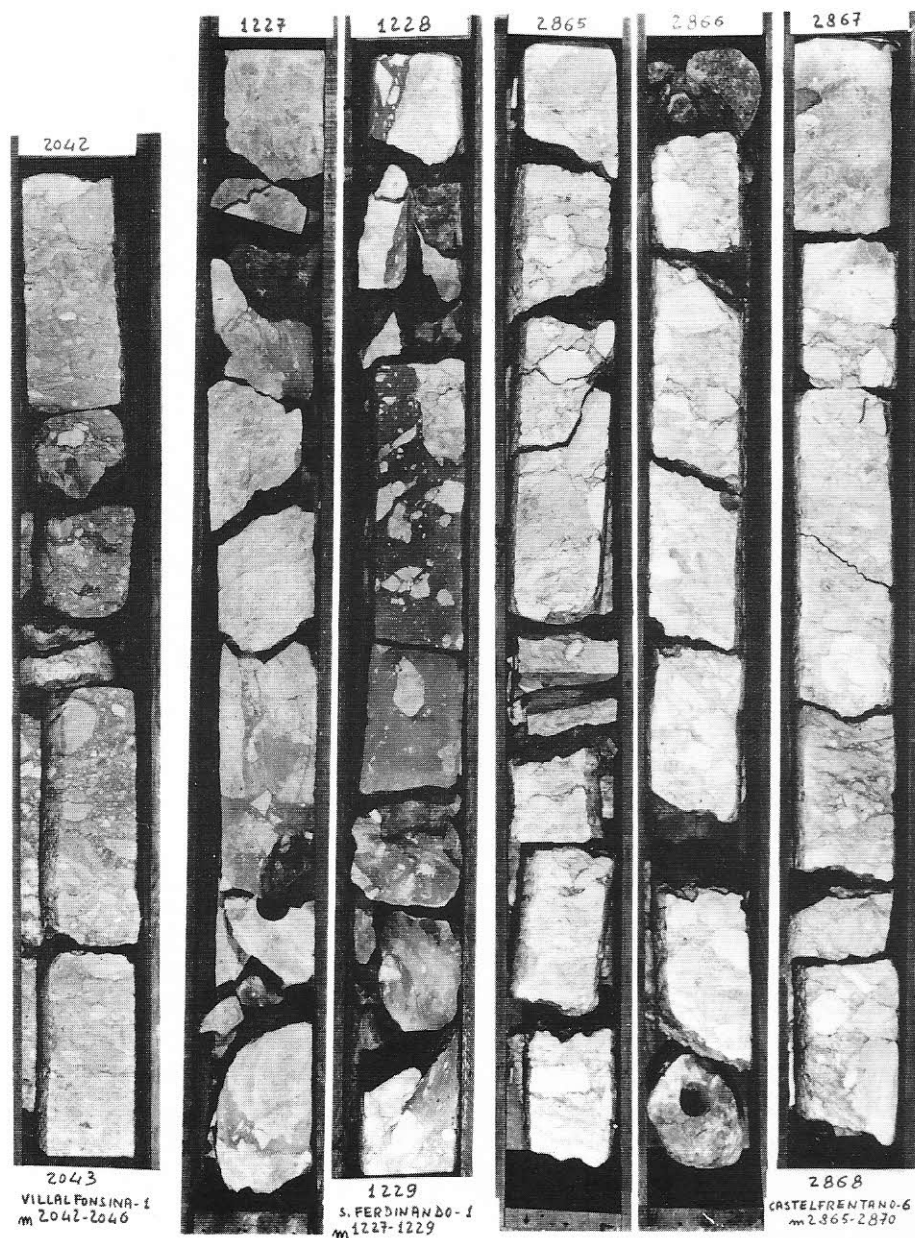
Fig. 3 — Carote di fondo dei pozzi di Villalfonsina 1, S. Ferdinando 1 e Castelfrentano 6: breccie calcaree di scarpata con variabili percentuali in matrice argillosa.
