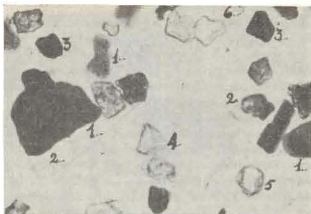
Fig. 6. Fracción granulométrica, de 53 a 200 micrones, de Densidad mayor a 2.82, proveniente de un material parental transportado por el viento. Muestra montada en Monobromonaftalina (n. 1.659).
