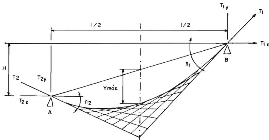
FIGURA 2. Deflexión de un cable que cuelga bajo la acción de su propio peso con soportes a diferente altura.
