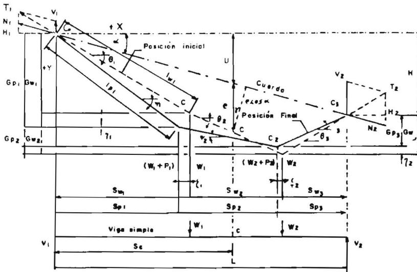
FIGURA 3. Cable aéreo con cargas concentradas  $W_i$  (iniciales) y  $P_i$  (finales) y su viga simple correspondiente.
