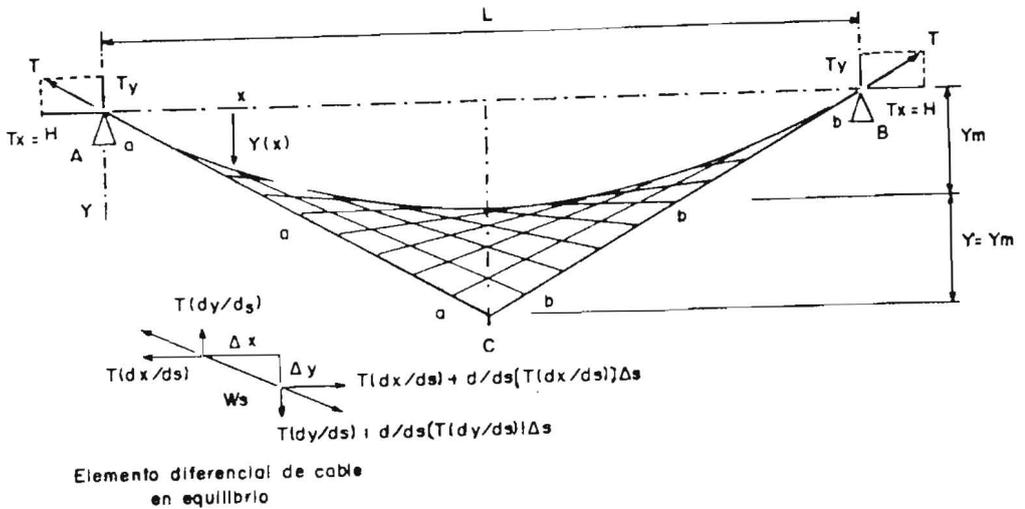
FIGURA 1. Dibujo de la línea elástica<sup>4</sup> o de la curva parabólica asumida por un cable aéreo que cuelga bajo la acción de su propio peso.
