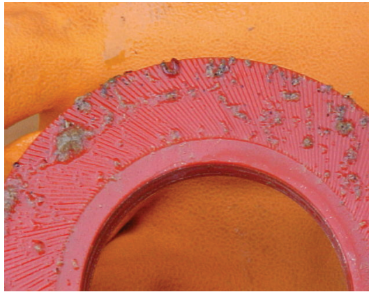
Figura 6. Material causante del taponamiento por agua residual, en uno de los discos del elemento filtrante.
