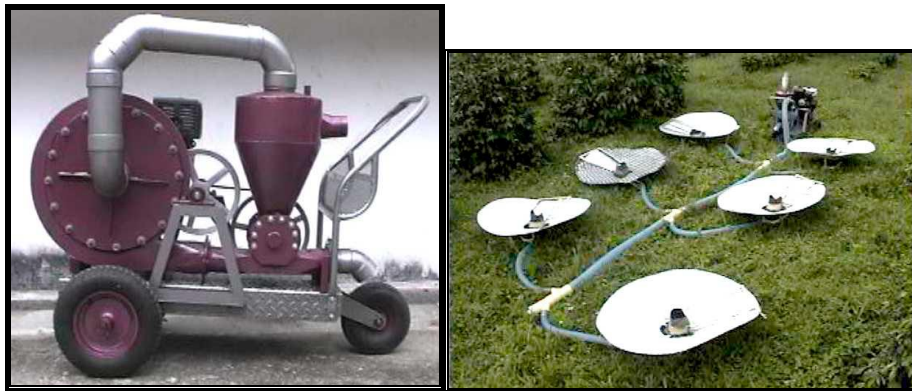
Figura 2. Equipo neumático para transportar café desde la base de los árboles diseñado por Palencia (14). Vista general del equipo (izquierda) y de las tolvas para la captura de frutos desprendidos y del sistema de transporte (derecha).
