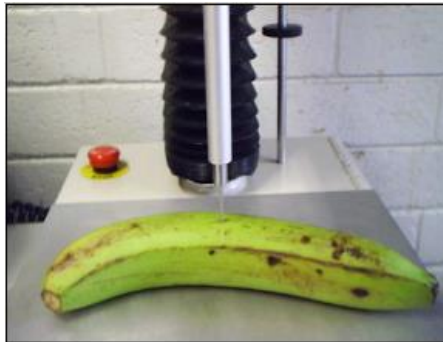
Figura 1. Prueba de firmeza por compresión unidireccional en banano var. Cavendish Valery.
