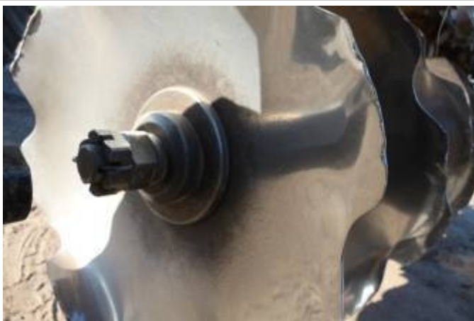
Рис. 5 – Вид робочої кромки диска виготовленого зі сталі 65Г в процесі експлуатації на ґрунтах з наявністю твердих включень
