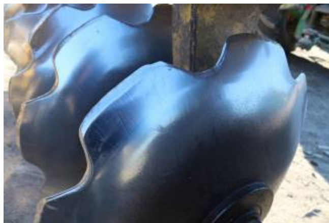
Рис. 4 – Поверхня тертя дискового робочого органу, який експлуатується на піщаних та супіщаних ґрунтах
