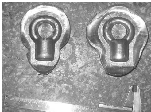
Рис. 14 – Сравнение поковок с облоем, отштампованных с профилированием заготовки продольным изгибом (слева) и по базовому варианту (справа)
