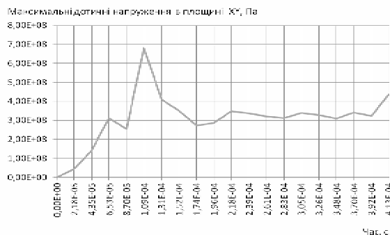
Рис. 4 – Максимальні дотичні напруження в площині XY під час руху кулі по каналу ствола
