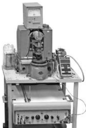
Рис. 1 – Загальний вигляд пристрою для визначення релаксаційної здатності матеріалів методом безперервного втискування індентора [2]
