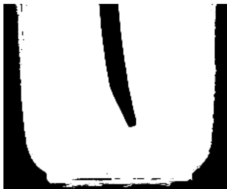
Рис. 6 – Отпечаток ножа, подверженного закалке ТВЧ, автогрейдера после эксплуатации
