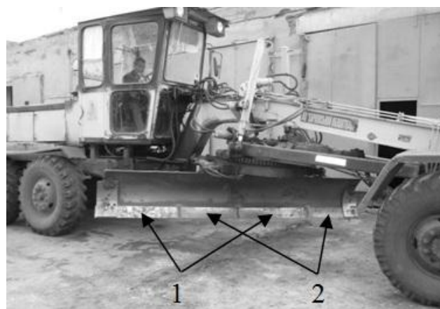
Рис. 2 – Общий вид автогрейдера ДЗ-180 с ножами: 1 – после закалки ТВЧ; 2 – с ТВЧ и покрытием TiN-Cr 2 N
