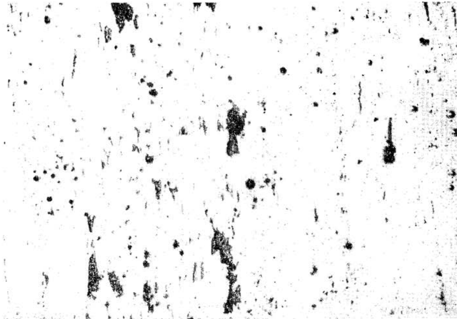
Poleerde Sektie by 15 x Vergroting, Yster wit, insluitels swar.
