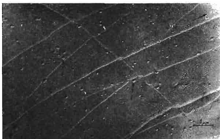
Rys. 5. Mikrofotografie replik powierzchni zerwanych fragmentów zużonego monofilamentu. Na niektórych mikrofotografiach strzałką przerywaną zaznaczono liczne zanieczyszczenia dwutlenkiem tytanu
