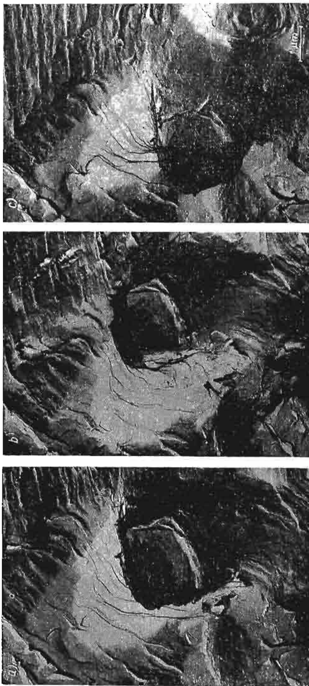
Rys. 7. Powierzchnia złomu zmęczeniowego stopu PA6 z pęknięciem łupliwym w wydzieleniu fazy wtórnej przy nachyleniu replik 0^\circ (a), -30^\circ (b) i +30^\circ (c); na ostatnim zdjęciu widać wystającą kolumnkę wydzielenia ponad powierzchnię głównego pęknięcia
