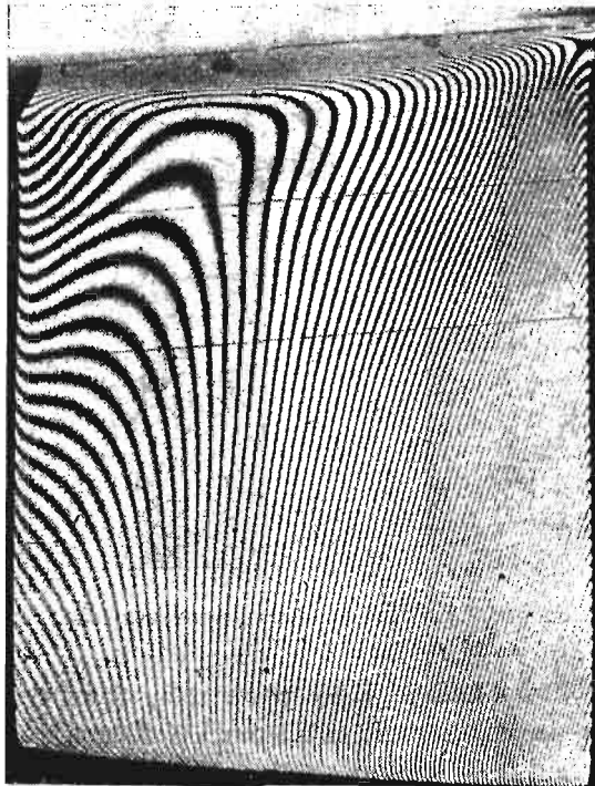
Rys. 5. Powierzchnia łopatki turbiny pokryta prążkami warstwicznymi.
