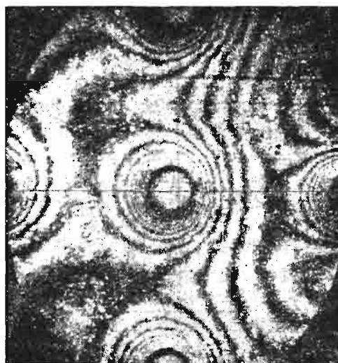
Rys. 12. Układ warstwic na powierzchni tego samego modelu, przy docisku większą siłą
