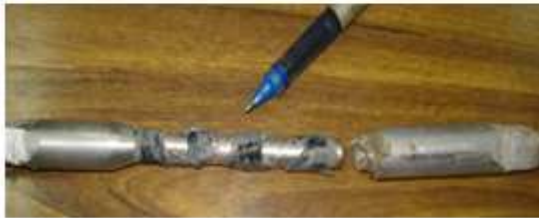
شكل رقم ٧ يوضح الفشل لعينات الألمنيوم المقواة بشرائح ألياف الكربون مع عينة المقارنة
