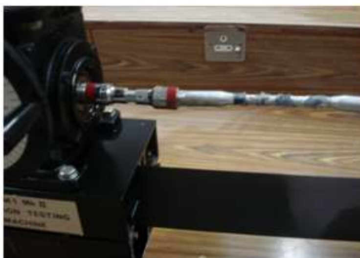
شكل رقم ٢ يبين أحد طرفي تثبيت العينة في جهاز تسليط عزم ألتواء
