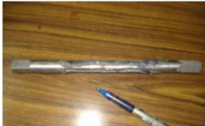
شكل رقم ٥ عينة الألمنيوم المقواة بشرائح ألياف الكربون طولياً
