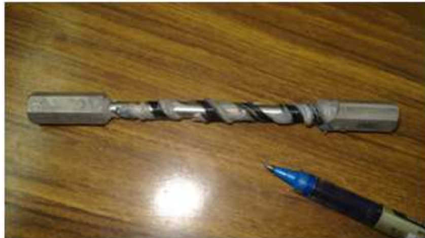
شكل رقم ٤ عينة الألمنيوم المقواة بشريحة ألياف الكربون حلزونية
