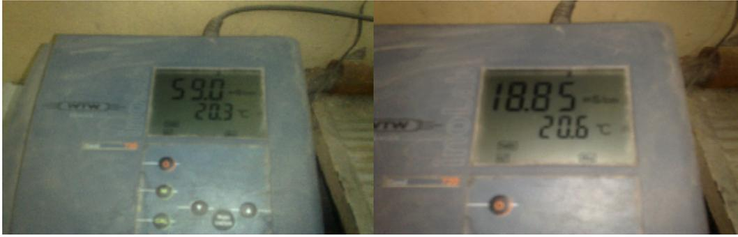
صورة رقم (٦) تبين بعض قراءات قياس التوصيلية المقاسة ( $\sigma_0$ ) عند درجة حرارة المحلول (٥)
