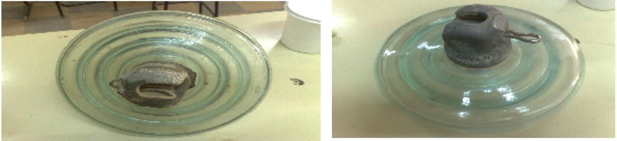
صورة رقم (٢) تبين العازل الزجاجي (132KV) المنتخب للفحص صورة رقم (٣) تبين العازل الزجاجي (33KV) المنتخب للفحص
