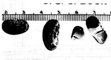
FIGURA 1. Forma, tamaño y daño mecánico del frijol Adzuki.
