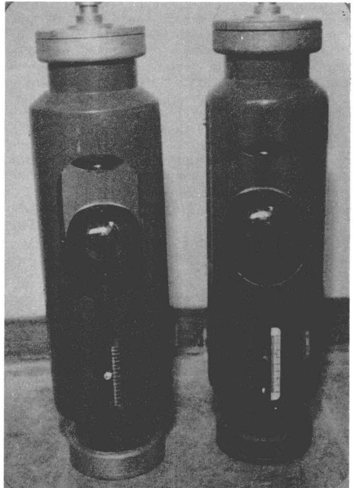
FIGURA 10. Aspecto de los explosores de recorte y encendido. El de la izquierda se fabricó en este proyecto. El derecho es el original de la firma alemana Messwandlerbau.
