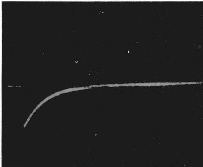
FIGURA 15. Onda de choque completa se aprecia la sincronización del osciloscopio.
