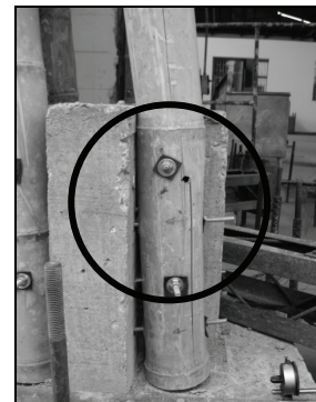
Figura 27. Desgarramiento de la solera inferior
