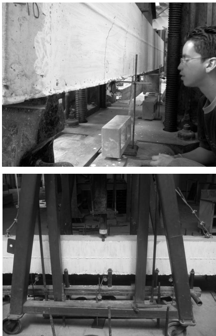
Figura 4. Localización de deformímetros mecánicos
