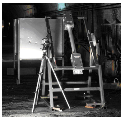
Figura 4: Banco di sostegno e sistema per la misura della velocità residua
