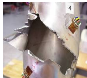
Figura 13: Fotografia del provino danneggiato al termine della prova statica.
