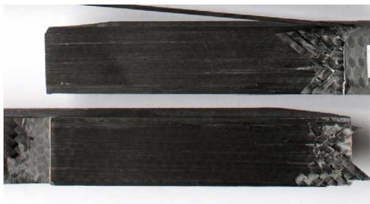
Figura 7: Superficie di frattura di un TC 110,8 mm.
