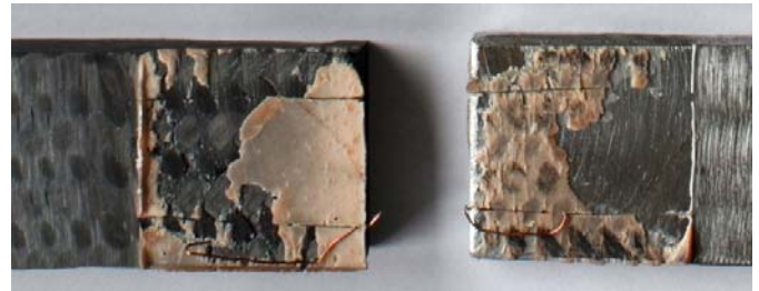
Figura 5: Superficie di frattura di un giunto SC 25,4 mm.
