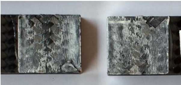
Figura 4: Superficie di frattura di un giunto LS 25,4 mm.
