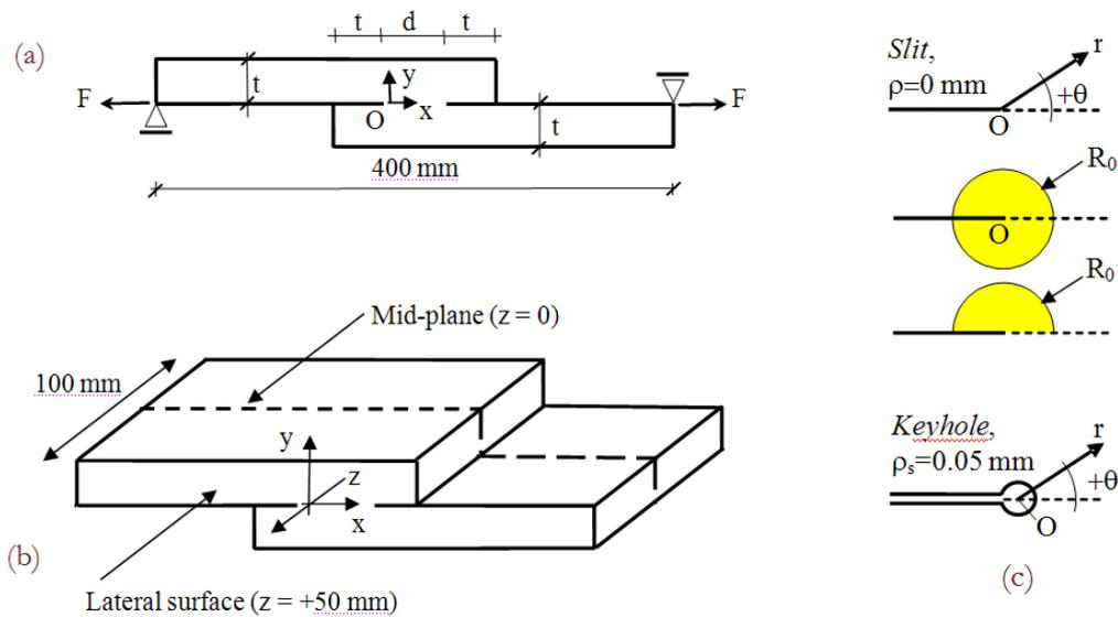
Figura 10: Giunto a sovrapposizione. Modello bidimensionale avente l'origine del piano x-y posizionato in corrispondenza della radice (a); modello tridimensionale con coordinata  $z=0$  nel piano medio del giunto (b); volumi di controllo per i modelli con  $\rho=0$  e modello con keyhole (c). Tensione nominale sempre riferita alla componente membranale,  $\sigma_{nom}=F/t$ .
