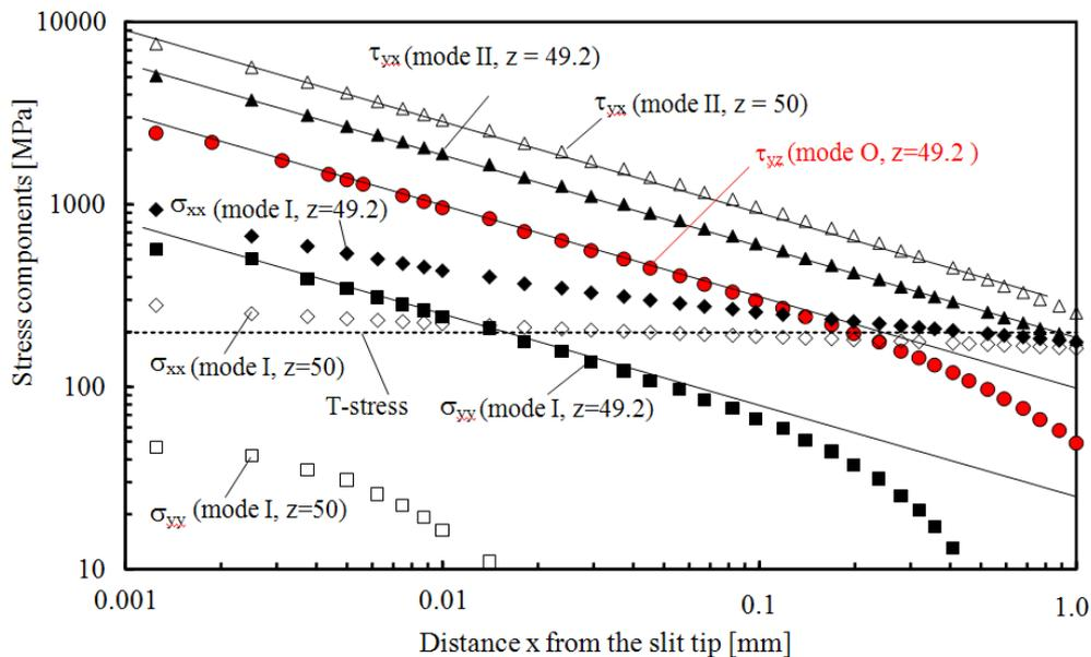
Figura 12: Componenti di tensione in due diversi piani in funzione della distanza  $x$  dal punto di singolarità: tensioni sulla superficie laterale del giunto ( $z=50$  mm) e su una superficie immediatamente adiacente ( $z=49.2$  mm). Stessa geometria di figura precedente (da Harding et al. [29]).
