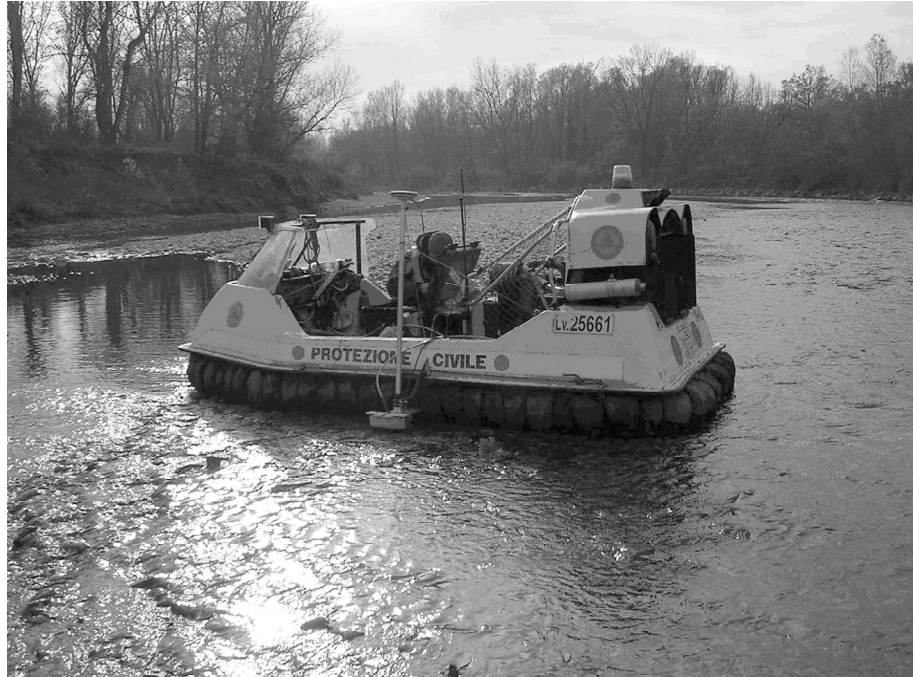
Fig. 3 - Hovercraft allestito con un supporto verticale dotato di sensori single beam e GPS RTK.
